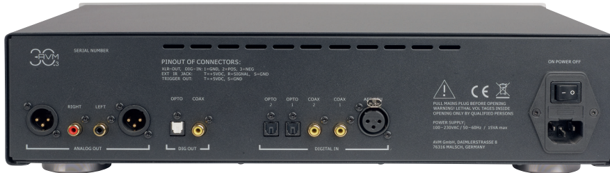
Der interne DAC des CD 30.3 kann auch von externen Quellgeräten genutzt werden
